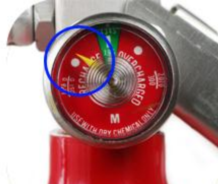
เครื่องดับเพลิง สภาพขัดข้อง (เข็มชี้ช่องแดง)
